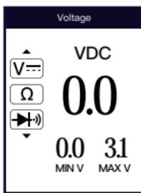
Appuyez sur le bouton "HAUT/BAS" pour sélectionner le mode de test. Appuyez sur le bouton "ESC" pour sortir.
